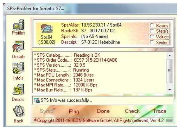
Schritt 3: Bei der Funktion „Check“ werden zusätzliche Informationen bzw. Kenndaten zum SPS-System ausgewiesen.
