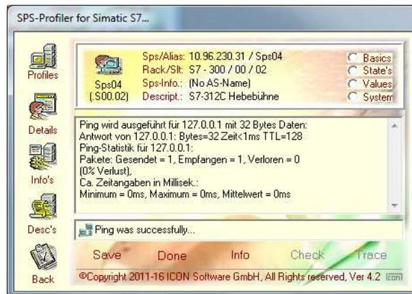
Schritt 2: Es wird der erfolgreiche Zugang zum gewünschten SPS-System mittels der Funktion „Info“ getestet. Es werden Informationen zur Baugruppe angezeigt:
